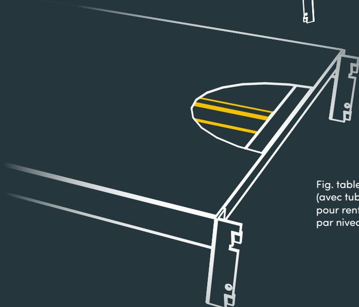
Fig. tablette Fliclass Type 200 (avec tube central sous le plateau pour renforcer la charge admissible par niveau).
