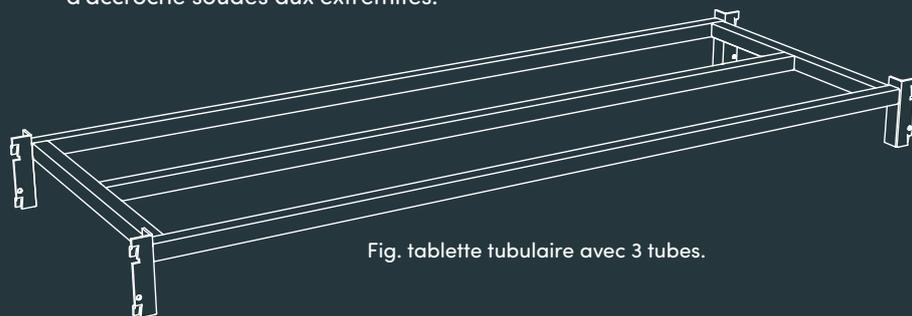
Fig. tablette tubulaire avec 3 tubes.
