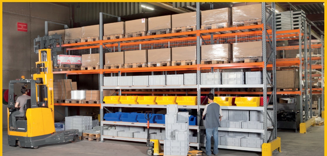
Das „Hybrid“-Regal Epsirack für die Lagerung von schweren Lasten auf Palette und für Picking-Anwendungen.
