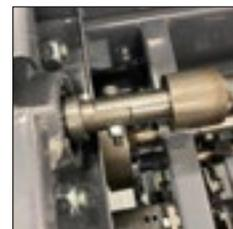
Jonction des axes de transmission par vis traversantes pour plus de fiabilité.
